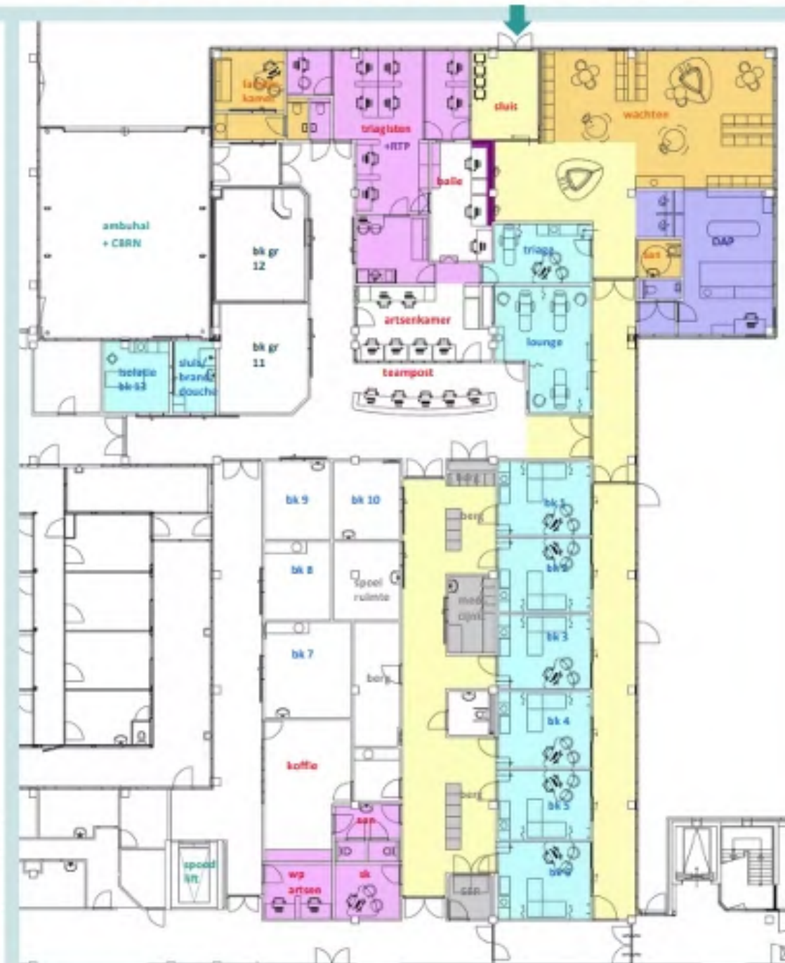
Vastgestelde plattegrond - verbouw
